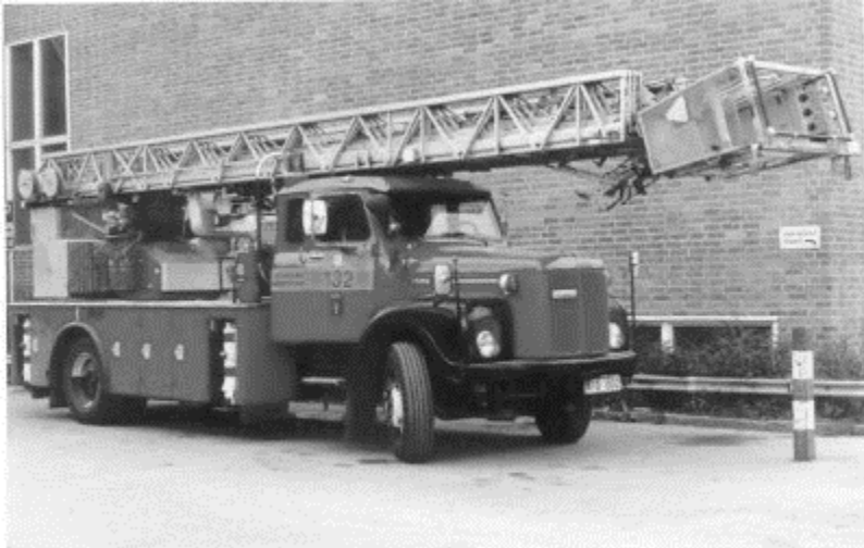
132 Stegbil Scania L 80 Årsmodell: 1978 Påbyggare: METZ Feuerwehrrgeräte GmbH Stegpaket: Metz 30M med arbetskorg
