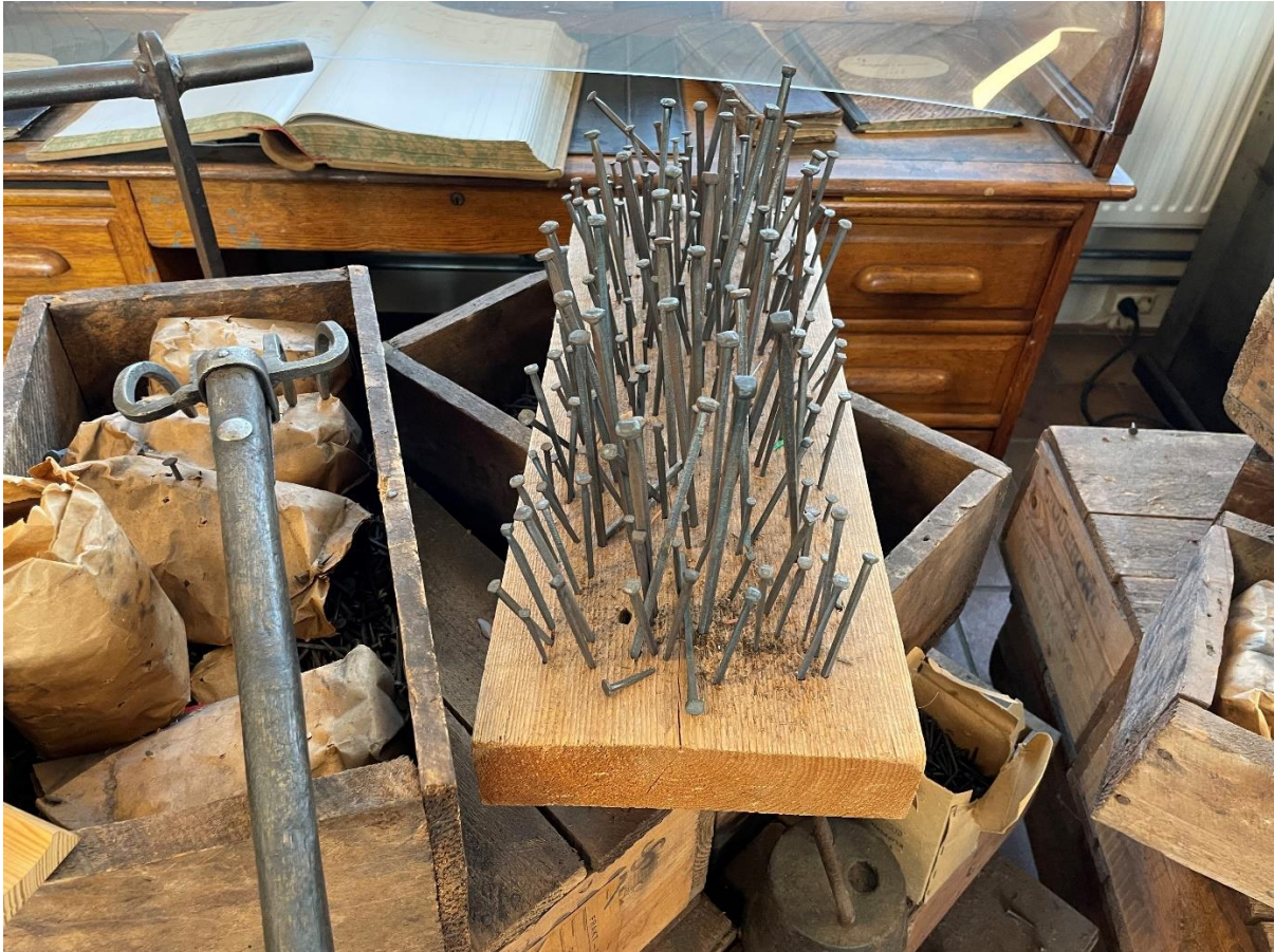
Färdigklippt spik (klipptes ur plåt). Fanns i olika dimensioner.
